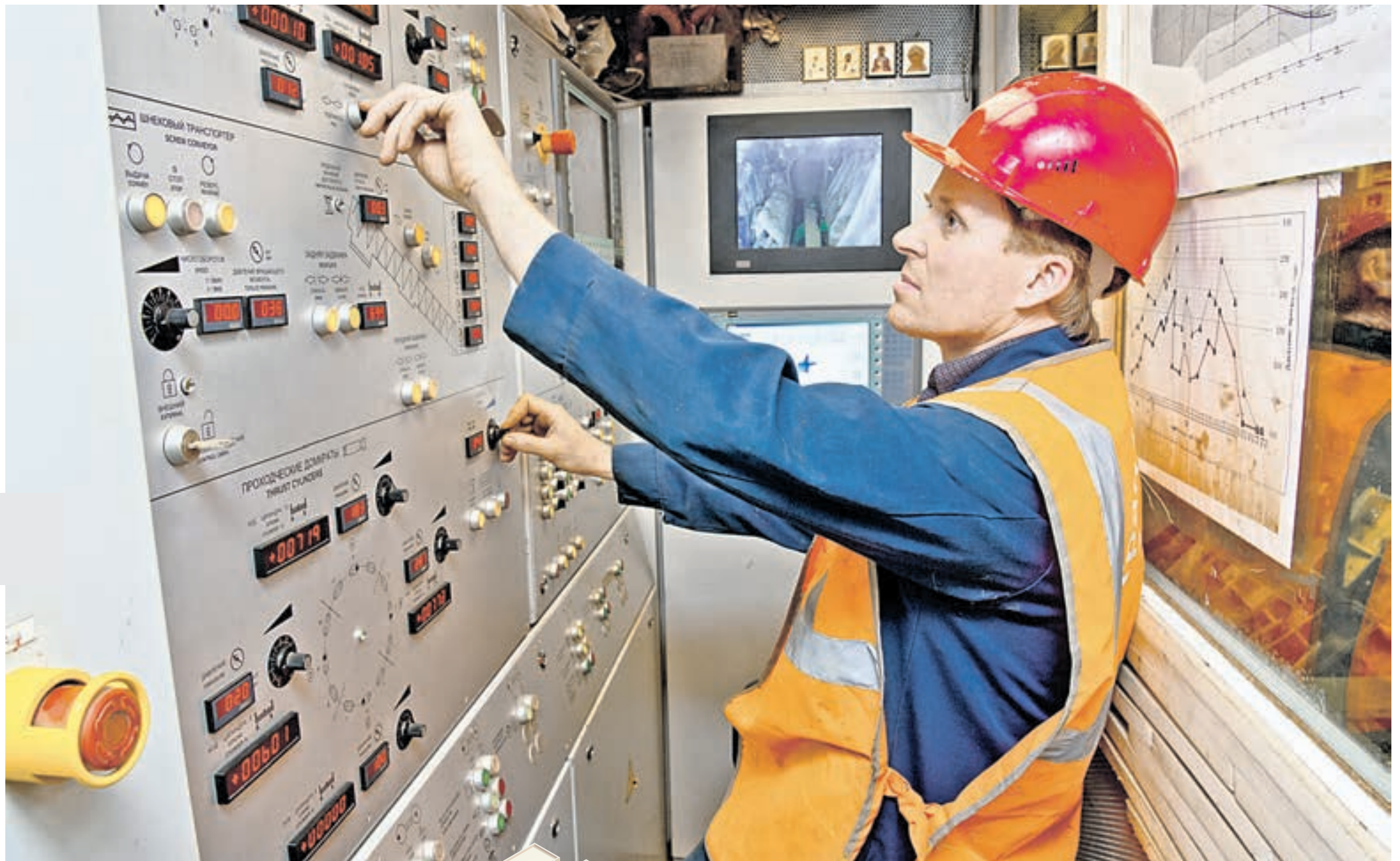
«Командный пост» современного механизированного тоннелепроходческого комплекса (ТПМК) Herrenknecht, которому по московской традиции дали имя «Наталья». Сейчас «Наталья» идет на 30-метровой глубине от станции «Ломоносовский проспект» к станции «Парк Победы» строящейся Солнеческой линии метро. Параллельно ей движется ТПМК «Людмила». Движение по участку «Деловой центр» — «Раменки» откроют в 2016 году
