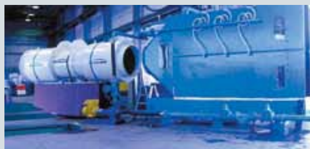
Рис. 11. Оборудование фирмы CFT (Германия) для вентиляции и поддержания комфортной температуры воздуха в выработках: а) обеспылеватель; б) охлаждающая установка
