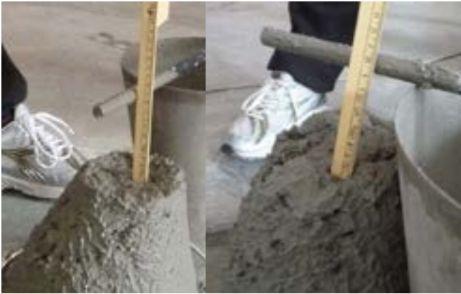
Рис. 5. Осадка конуса (определение подвижности бетонной смеси): слева — бетонная смесь без фибры; справа — добавление фибры из расчета 8 кг/м³
