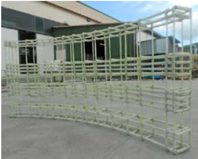
Рис. 3. Пространственный каркас для армирования блоков высокоточной обделки
