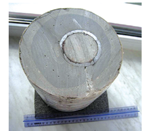
Рис. 8. Анкерная свая «Атлант мини-джет» (слева); свая и армирующий элемент (в разрезе) (справа)
