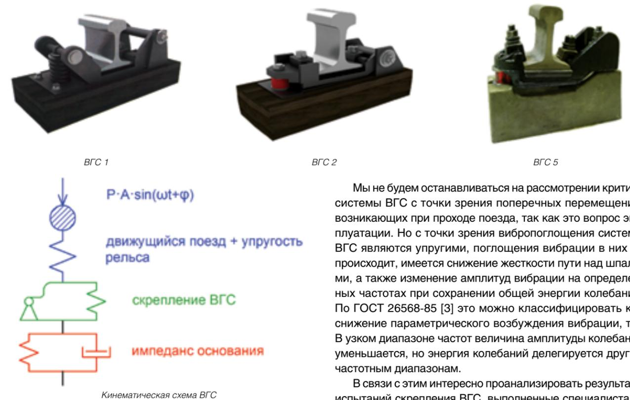
Рис. 3. Модификации виброзащитных креплений и кинематическая схема ВГС
