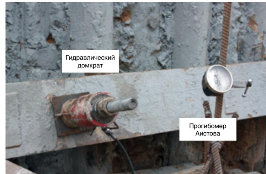
Рис. 4. Процесс испытания анкеров
