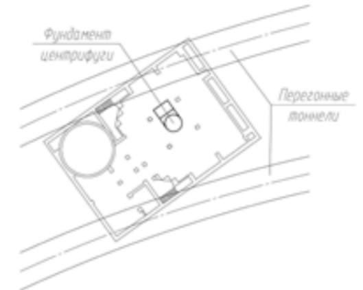
Рис. 1. План расположения перегонных тоннелей и здания центрифуги
