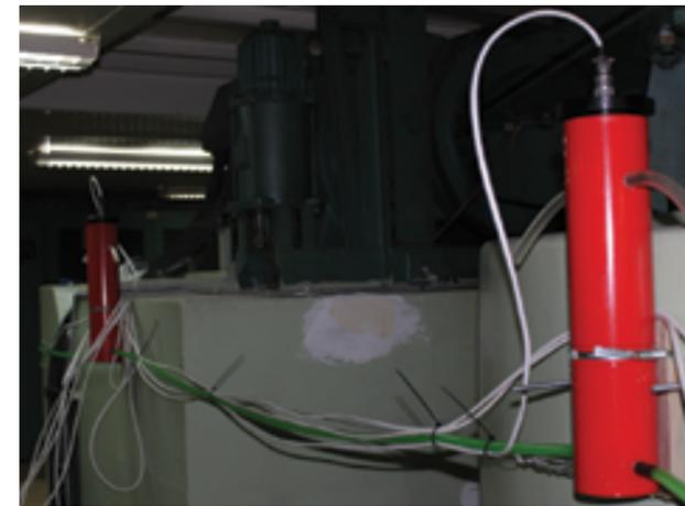
Рис. 5. Датчики гидростатического нивелирования, установленные на фундаменте центрифуги
