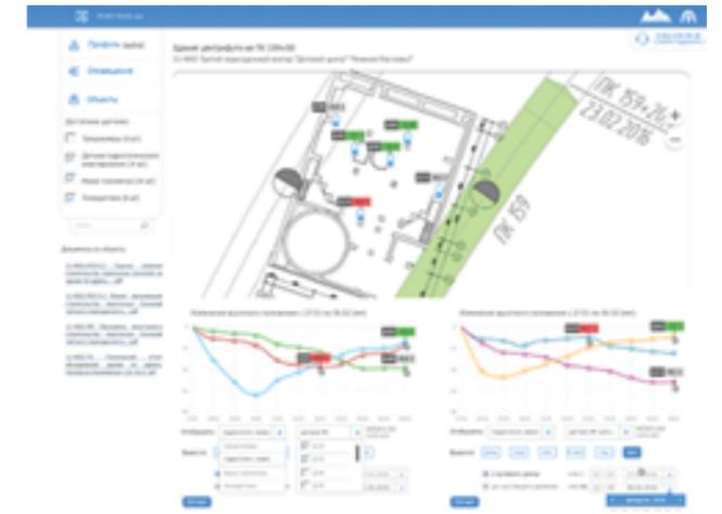
Рис. 6. Отображение информации по высотному положению фундамента через сеть Интернет в программном комплексе Monitron.xyz
