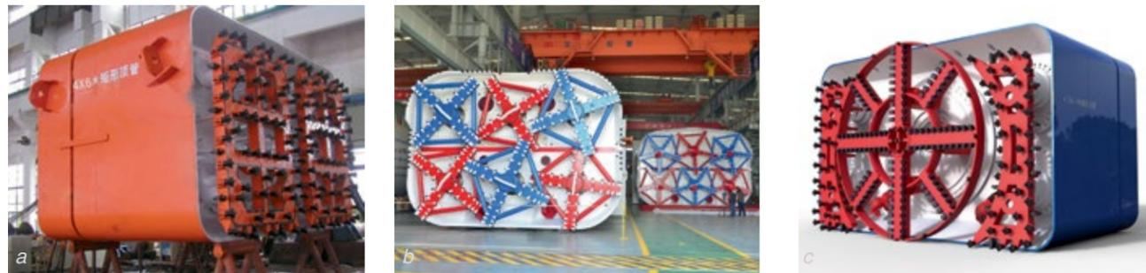
Рис. 2. Породоразрушающий инструмент для прямоугольной выработки: а — с эксцентричным рабочим органом (фрезой); б — с несколькими рабочими органами; с — комбинация эксцентричного рабочего органа и концепции нескольких рабочих органов
