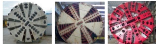
Рис. 2. Роторы — «рабочие органы» — ТПМК Herrenknecht, Lovat и Terratec
