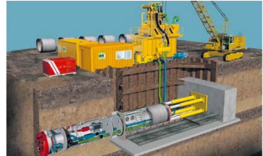
Рис. 48. Схематическое изображение строительной площадки с сепарационной установкой
