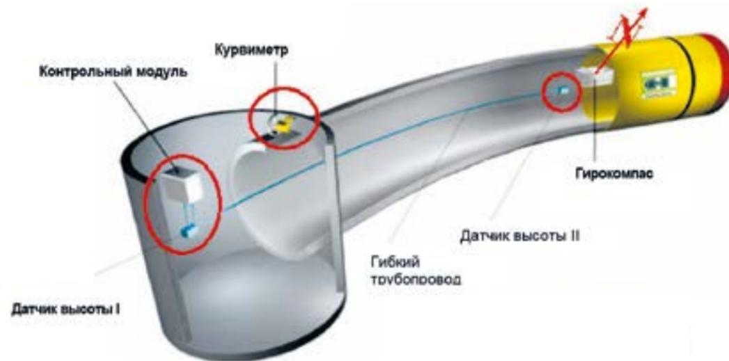
Рис. 42. Блок-схема устройства гироскопа с водяным уровнем
